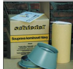
37. «Комплект для монтажа верхней части дымовой трубы» с готовой покровной плитой включает: керамическую трубу, распорное кольцо, конус, герметик, уплотнительную массу и наглядную инструкцию по монтажу. При использовании готовых элементов для монтажа верхней части дымовой трубы консольная и покровная плиты не устанавливаются.
