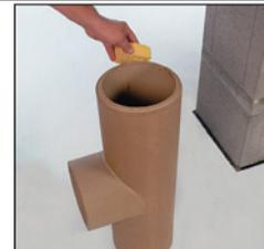
18. Очистите нижнюю грань тройника для подключения потребителя и в случае использования сухой массы для заделки швов смочите влажной губкой. При использовании герметиков в трубе, нанесите их непосредственно в канавку верхнего края внутренней керамической трубы без предварительного смазывания керамического элемента.
