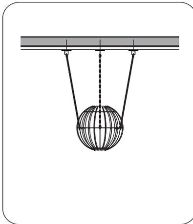
**FI** Saunan rakenteiden tulee kestää kiukaan paino. Valitse kiinnitysruuvit rakenteiden materiaalin mukaan. Mukana toimitetut kiinnitysruuvit soveltuvat puulle.
