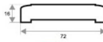
Погонажные изделия производятся из цельной древесины без сучков и дефектов. Плинтус сечением 15x43 мм – закрывает стык пола и стен. Галтель сечением 18x18 мм – закрывает стык стен и потолка. Грибок 15x30 мм – для стыковки коротких размеров евровагонки, что несомненно уменьшает Ваши расходы. Уголок сечением 27x27 мм – для оформления наружных углов стен. Наличник сечением 16x72 мм – для оформления дверей и окон, комплект по 5 штук, длина от 1.8 м до 2.2 м.
